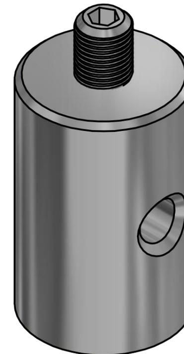
Стойки из нержавеющей стали Ø12,7 мм. На одном конце имеется резьбовое отверстие М6, а на другом - съемный установочный винт М4. Расположенное сбоку отверстие Ø3,5 мм просверливается прямо в стойке, использование которого, обеспечивает дополнительный рычаг при затягивании смонтированных компонентов.
