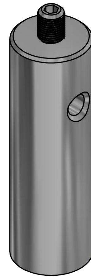
Стойки из нержавеющей стали  $\varnothing 12,7$  мм. На одном конце имеется резьбовое отверстие М6, а на другом - съемный установочный винт М4. Расположенное сбоку отверстие  $\varnothing 3,5$  мм просверливается прямо в стойке, использование которого, обеспечивает дополнительный рычаг при затягивании смонтированных компонентов.
