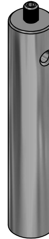
Стойки из нержавеющей стали Ø12,7 мм. На одном конце имеется резьбовое отверстие М6, а на другом - съемный установочный винт М4. Расположенное сбоку отверстие Ø3,5 мм просверливается прямо в стойке, использование которого, обеспечивает дополнительный рычаг при затягивании смонтированных компонентов.
